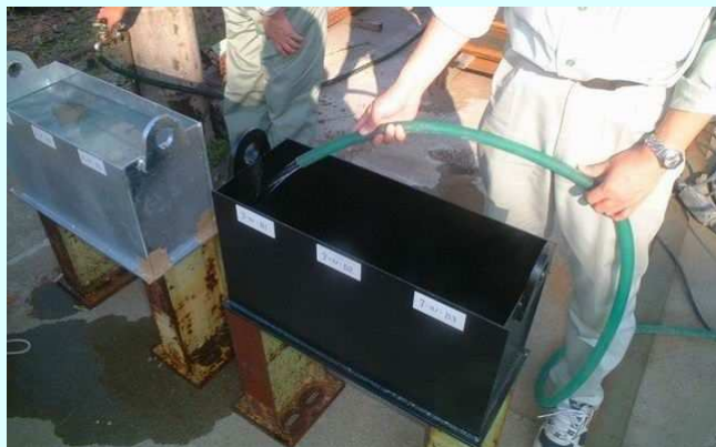
水張り試験状況
